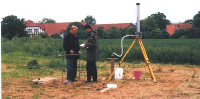
Die Ingenieurgesellschaft für Stadthydrologie (**ifs**) führt Untersuchungen zum standortspezifischen Bodenaufbau und zur Versickerungsfähigkeit des Untergrundes durch.
